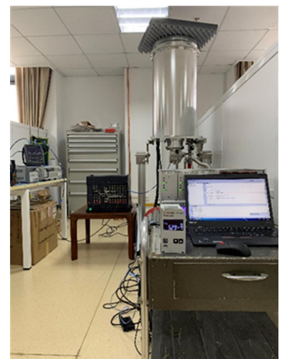
图 3 天马望远镜 K 波段 7 波束低温接收机
