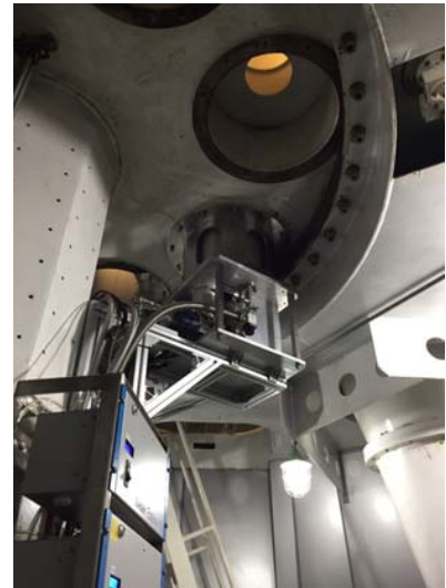
图 1 天马望远镜 Q 波段双波束低温接收机
