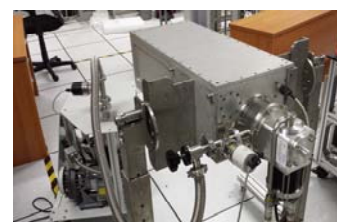
图 6 实验室内的 K 波段双波束致冷接收机
