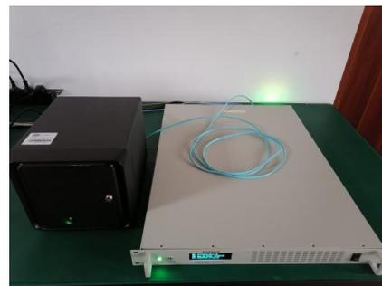
图 6 宽带谱线终端和数据记录服务器
