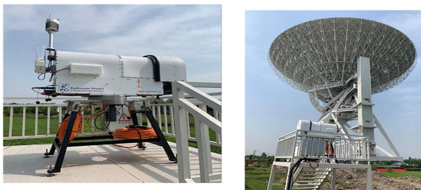
图9 天马望远镜园区安装的水汽辐射计
