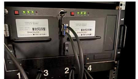
图7 VLBI 基带数据高速记录系统样机
