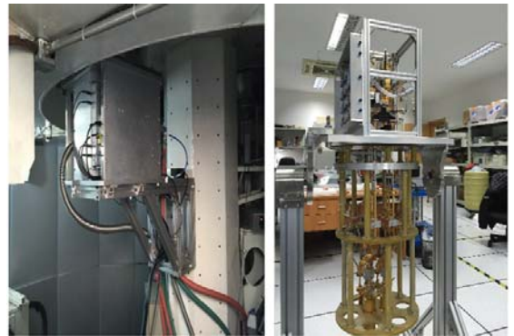
图 1 Q 波段双波束低温接收机安装于天马望远镜
